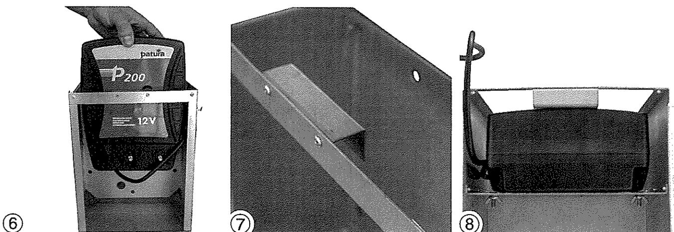
Fixer la plaque d'adaptation avec le poste dans le boîtier à l'aide de 2 vis M6 x 16 et des écrous papillon M6. Installer ensuite le support d'angle en haut, devant l'appareil, à l'aide des 2 rivets aveugles.
