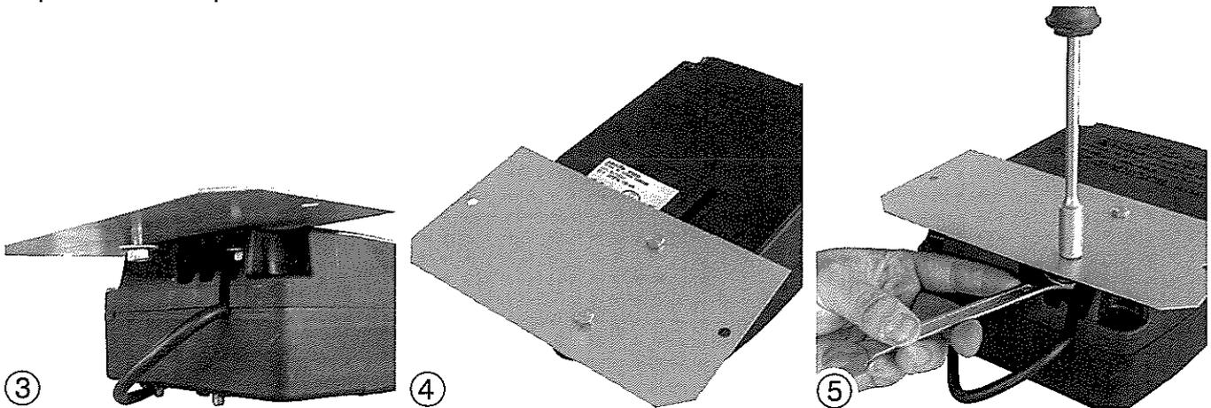
Faire glisser les vis avec les écrous et les rondelles dans la fente de montage à l'arrière de l'électrificateur puis serrer les écrous.
