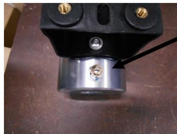
Faites fonctionner le circulateur seul sans faire fonctionner l'élément chauffant le temps nécessaire pour évacuer l'air encore présent dans le circuit d'eau :
